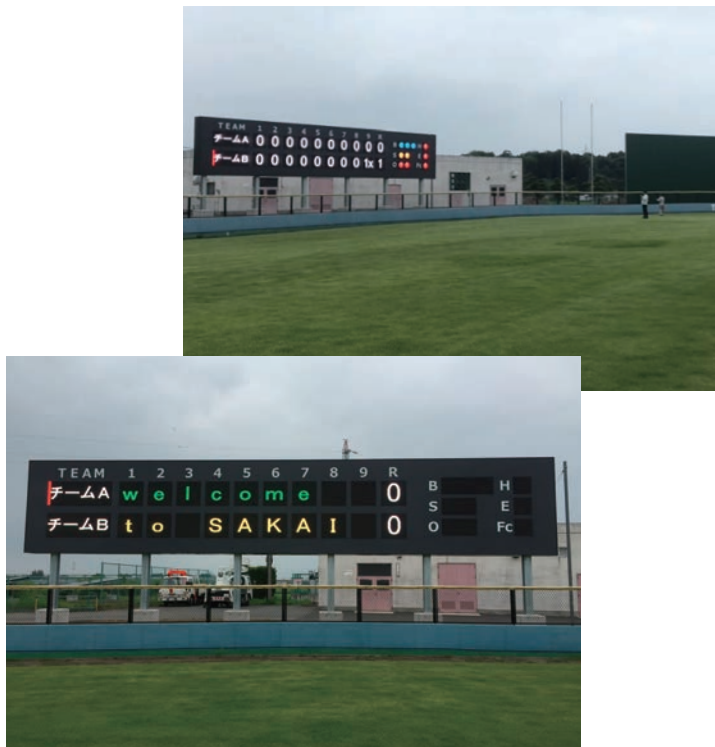
猿島球場スコアボード フルカラーLED 15mm ピッチ 786×112 pixels
