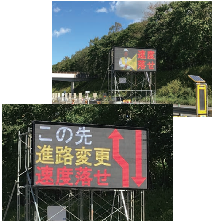
注意喚起LEDビジョン GRAVO6 横3×縦2台連結 576×288 pixels
